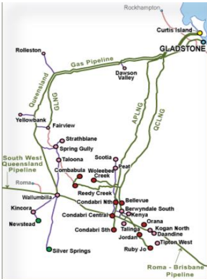
Figure 3-9 LNG Pipelines Map
