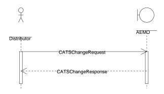
FIGURE 4-6. DELIVERING STANDING DATA SEQUENCE DIAGRAM
