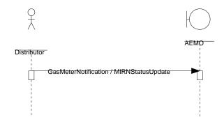
FIGURE 4-36. MIRN STATUS UPDATE NOTIFICATION SEQUENCE DIAGRAM
